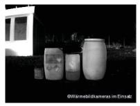
Bei Licht sind die Warnhinweise auf den Fässern optisch zu erkennen (Bild links). Das Bild der Wärmebildkamera zeigt die Flächen mit den Warnhinweisen nicht oder nur mehr teilweise an (Bild rechts). Dies hängt mit den unterschiedlichen Emissionswerten der verwendeten Aufkleberflächen zusammen.
