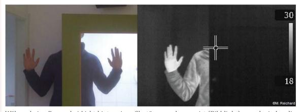
Während eine Person bei Licht hinter einer Glastüre zu erkennen ist (Bild links), verschwinden die Bereiche der Person, die sich hinter dem Glas befinden, auf der Anzeige der Wärmebildkamera (Bild rechts).
