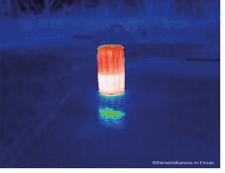
Oberflächen (Bilder oben) oder Wasserflächen (Bild unten) können Wärmestrahlung reflektieren.
